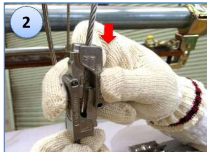
片方のワイヤロープをSC金具の矢印(1→2)方向に挿入する。
