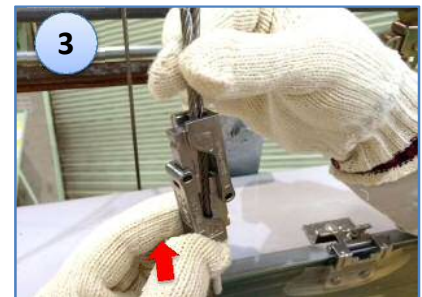
もう一方のワイヤロープをSC金具の矢印(1→2)方向に挿入して引き出す。
