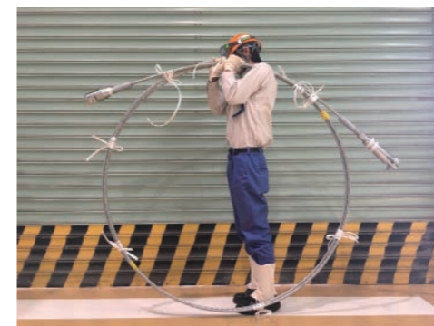
φ15.2mm、長さ15mのケーブルを巻いた状態
