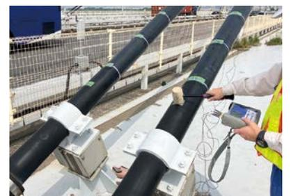
当社の高次振動法による張力測定システムは、従来の振動法に比べて以下の特長を有しています。
