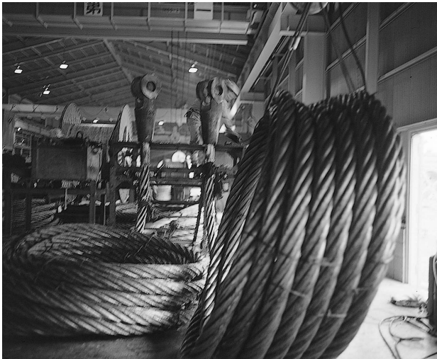
120mmロープのワイヤソケット加工
