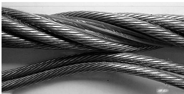
図 4.4 デルタフィラーロープの内部
