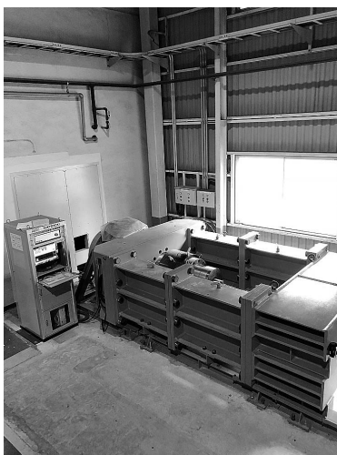
2000kN引張疲労試験機
