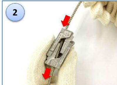
ワイヤロープをSC金具の矢印(1→2)方向に挿入する。
