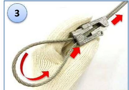
ワイヤロープを折り返して、SC金具の矢印(3→4)方向に挿入して引き出す。
