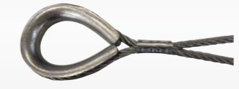
現場圧着シンコークランプ (株) 高速道路総合技術研究所 (NEXCO総研) 承認品 定着効率: 90%以上 (φ8mm以上), 95%以上 (φ6.3mm以下) ロープ径φ16mm以下の構造用ステンレス鋼ワイヤロープは、現場での圧着加工も可能です。
