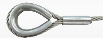
工場圧着シンコークランプ 定着効率: 95%以上 専用プレス機により、工場で圧着加工を行っています。
