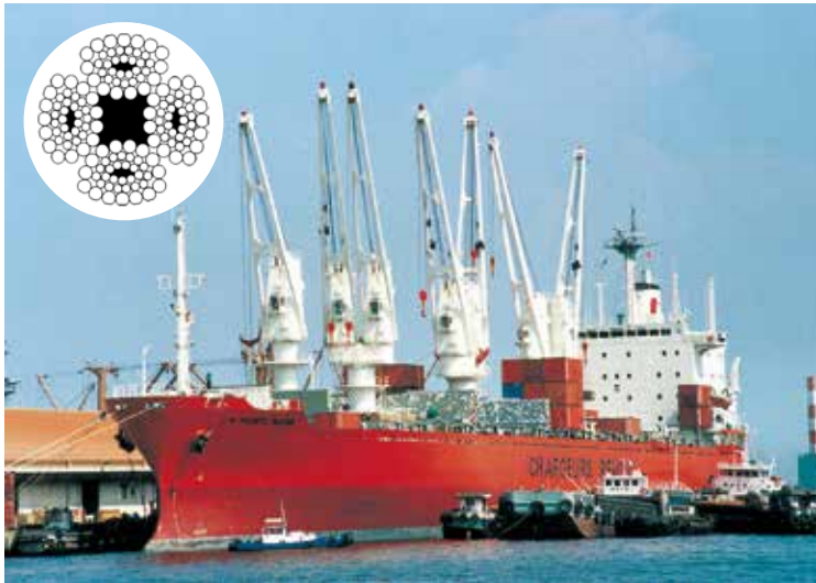
デッキクレーン Deck Crane
