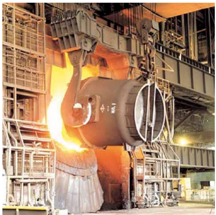
レードルクレーン Ladle Crane
